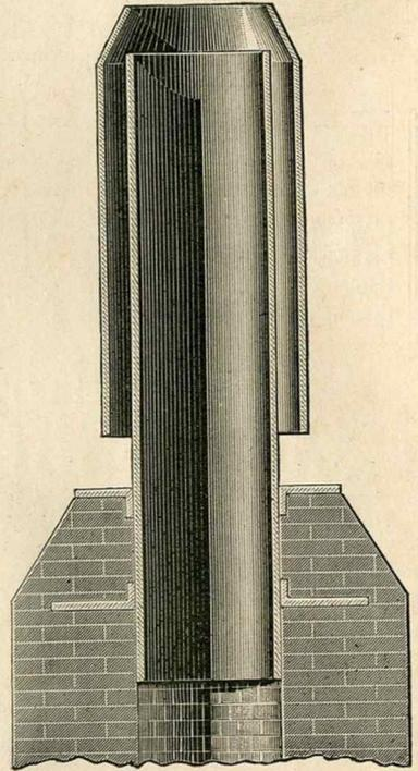
Cet appareil, par sa disposition, supprime les grandes hauteurs de tuyaux, nécessaires pour obvier à l'insuffisance de tirage des cheminées, et facilite l'échappement de la fumée, quelle que soit la direction du vent.
